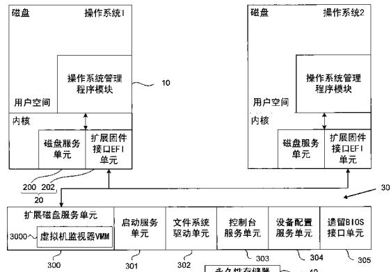
1. 一种基于固件的虚拟化平台系统,将虚拟机监视器 VMM 中的持久性数据放置在一个永久性存储器中,并利用该永久性存储器的固件从操作系统启动时就隐藏该永久性存储器,该虚拟化平台系统包括 :
